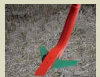
Standard-Pflugspitze in Kombination mit 30 cm Flügelscharen für flache Bearbeitungstiefen.
