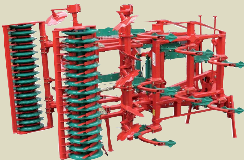
CLC pro - drei Zinkenreihen klappbar mit Hauptrahmen 200 x 200 mm
